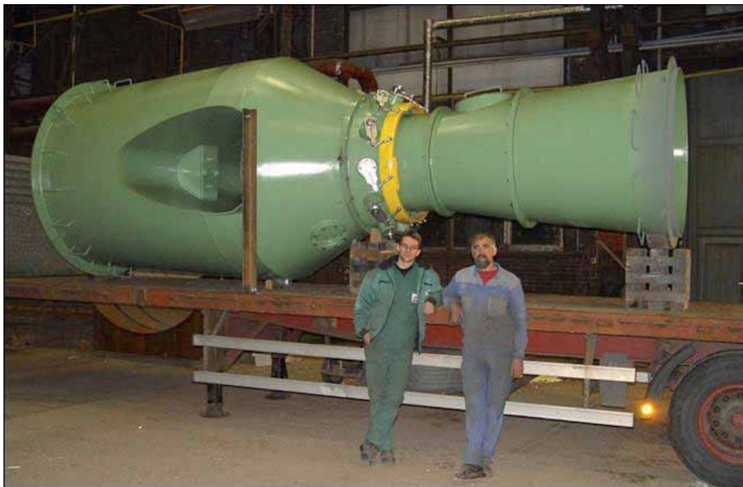
Kaplanrohrturbinen RD4-90 fertig montiert und auslieferungsbereit auf dem Tieflader
